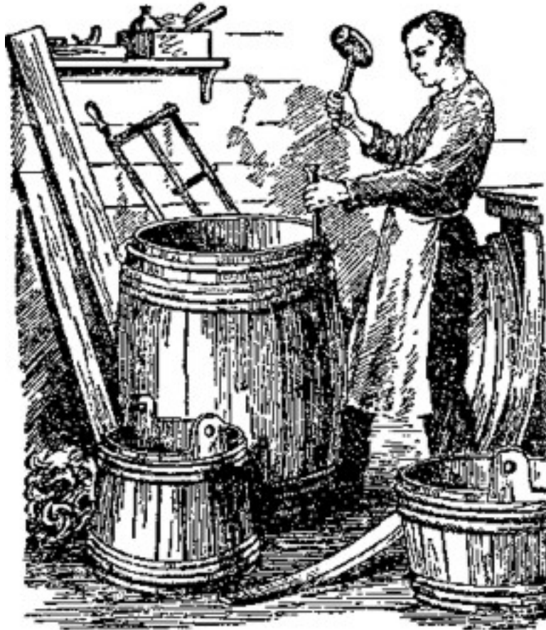
Figura 109. Acercando los zunchos a la parte más ancha del tonel se consigue rodearlo fuertemente
