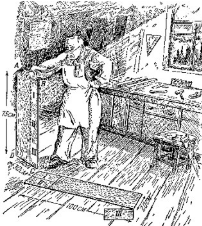
Figura 187. Como se alarga una tabla por medio de tres cortes y un encolado.
